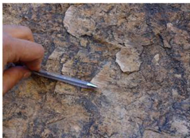
شکل ۸. نمونه‌هایی از آیینه‌های گسلی و خش خط روی آنها که برای تحلیل تنش دیرین مورد استفاده قرار گرفته‌اند.
