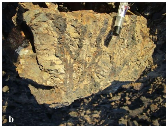
شکل ۷. (a) نمایی نزدیک از رگه کانی‌سازی سرب و روی در منطقه معدنی گله‌چاه. (b) نمایی از ساختار رگه‌ها در یک نمونه دستی به شکل رگه‌های متقاطع و استوک ورت.
