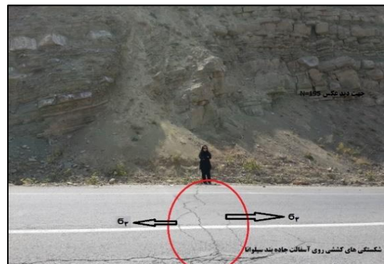
شکل ۵- نمایی از گسل خوردگی نرمال در منطقه مورد مطالعه با شیب ۷۵ و امتداد 170^\circ و جهت شیب SE می‌باشد.
