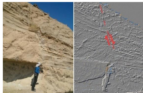
شکل ۵- نمایی از گسل خوردگی نرمال در منطقه مورد مطالعه با شیب ۷۵ و امتداد 170^\circ و جهت شیب SE می‌باشد.
