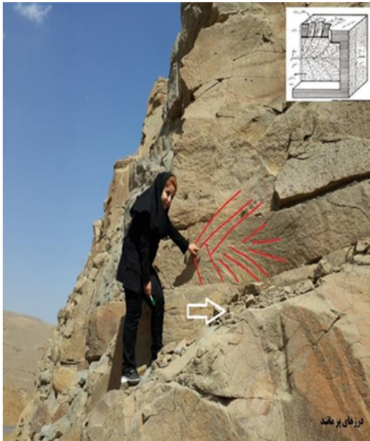
شکل ۱۴- شکستگی های پر مانند که جهت پیکان سفید رنگ نشان دهنده سمت تنش بیشینه است. جهت دید عکس N215°
