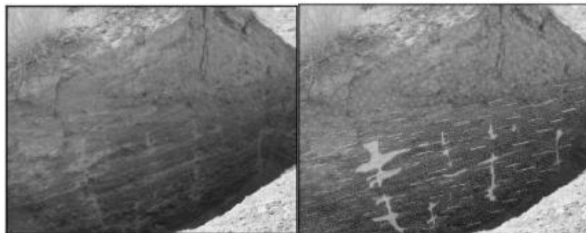
شکل ۶. مشاهده پدیده روانگرایی (Liquefaction) در ترانسه (T 3 ) حفر شده عمود بر راستای گسل. جهت مشاهده بهتر این پدیده، در تصویر پایین به صورت شماتیک نشان داده شده است.
