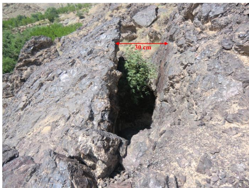
شکل ۳. تصویر یک شکستگی باز شده در بازالت که نشان از حرکت واحدهای زیرین دارد
