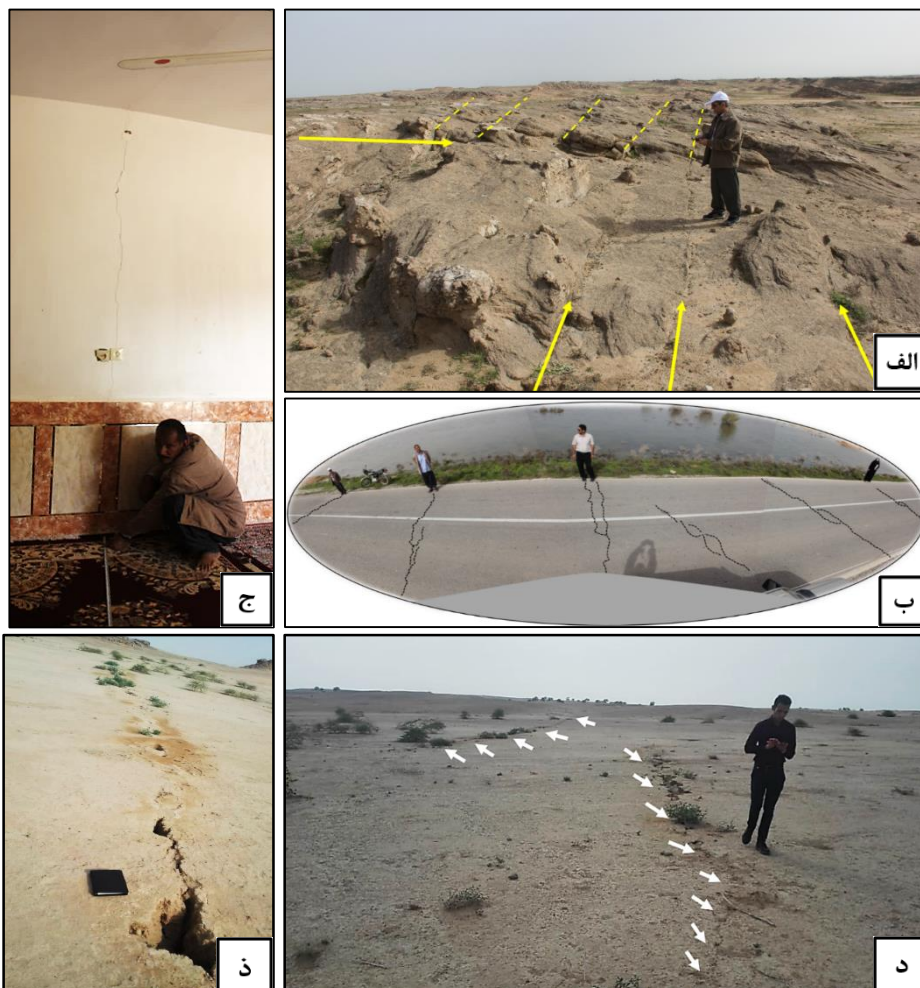
شکل ۶. نمونه‌هایی از شکاف‌های مرتبط با لرزه خیزی محدود مورد مطالعه (الف) درزه‌های رخنمون سازند لهری در منطقه گوریه (دید عکس به سمت جنوب شرق) (ب) شکاف‌های سیگموئیدال سطح جاده بنه کاظم به سمت شوشتر (دید عکس به سمت شمال غرب) (ج) نمونه‌ای از شکاف دیوار خانه‌ها (دید عکس به سمت شمال غرب) (د، ذ) شکاف سطحی ایجاد شده بر اثر رویداد فوج لرزه گوریه (۱۳۹۶-۱۳۹۷) (دید عکس به سمت شمال) (عکس از اژدری، ۱۳۹۶).
