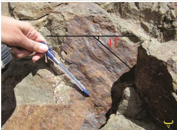
شکل ۱۱. الف) صفحه گسل علی آباد سورک. سوی نگاه خاور است، ب) استریوگراف صفحه گسل (fp) و موقعیت خط خش (sv) و پ) خط خش‌های موجود بر صفحه گسل (39S, 718595E, 3563111N).
